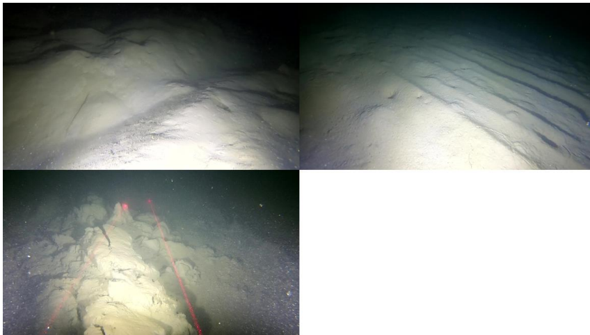
Figur 1. Trålsår: överst till vänster: ”ravin” efter trålbord (grad 1), överst till höger: parallella linjer av tråls släp (grad 2), nederst: kantiga uppkastade lerkokor (grad 3).
